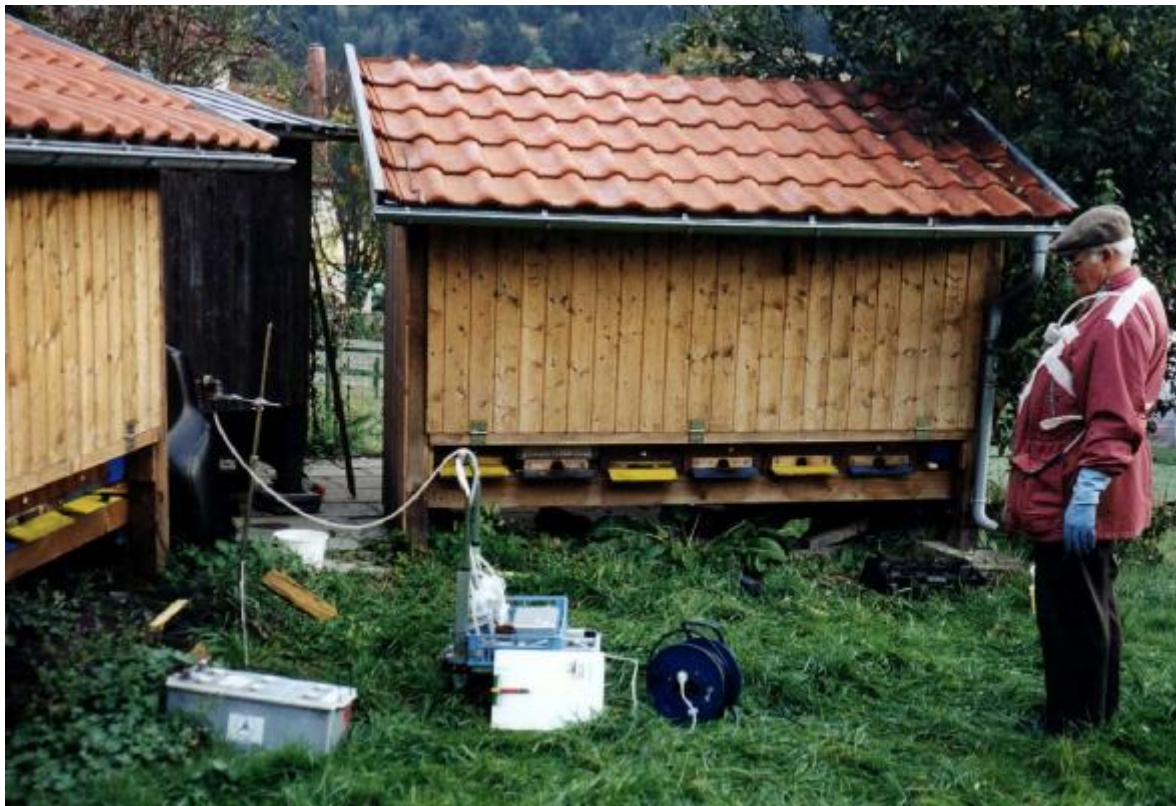
Abb 5: Die Probennahme-Apparatur steht vor dem Bienenstock, durch dessen Flugloch gerade eine Oxalsäure-Verdampfung durchgeführt wird. Der Imker beobachtet in einigem Abstand das Geschehen.
