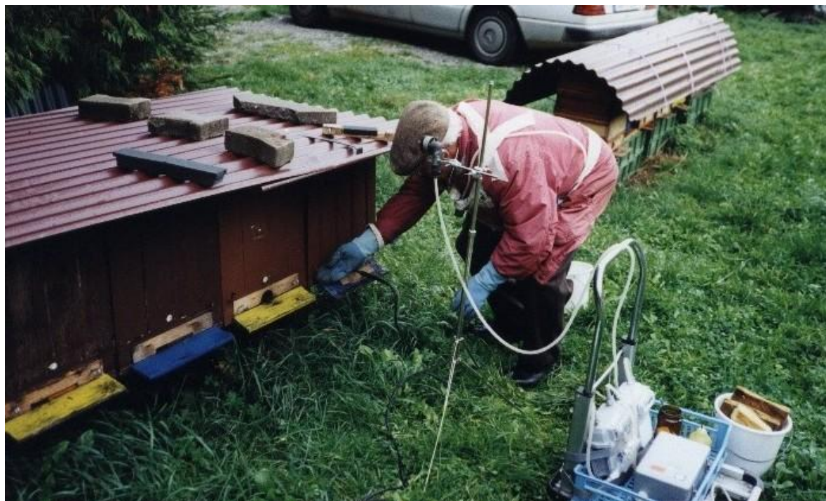
Abb 6: Der Imker beim Einführen des Varroa®-Verdampfers durch das Flugloch. Davor der auf einen Ständer montierte Probensammelkopf. Rechts die Luftsammelpumpe und das Volumenmeßgerät.
