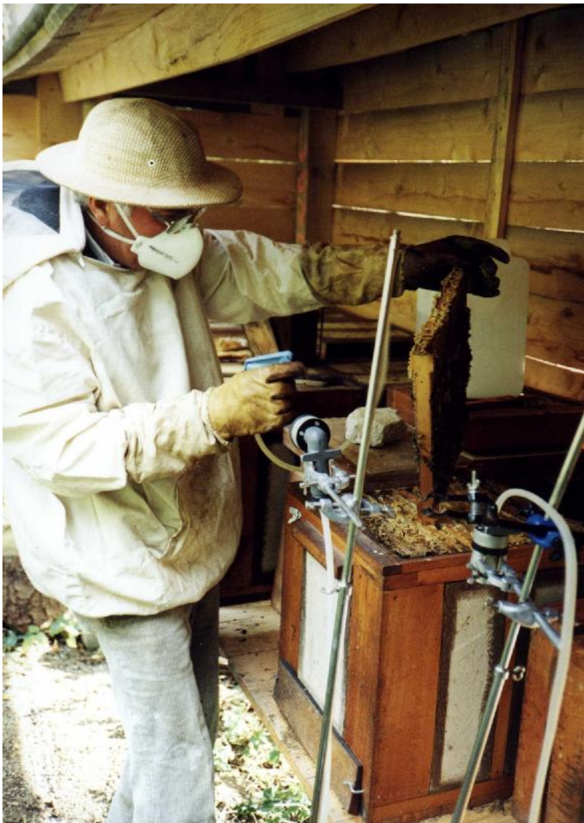
Abb 4: Platzierung der auf Ständer montierten Probensammelköpfe neben dem Arbeitsplatz des Imkers, der eine entnommene Wabe mit Oxalsäure-Lösung besprüht.
